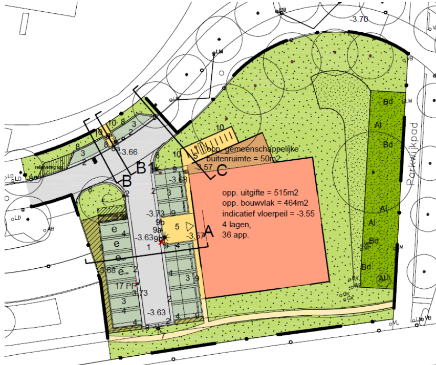
Afbeelding: bouwvlak en parkeerterrein (noord)
